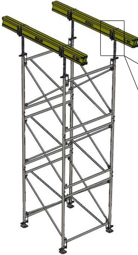
Şekil 4.5. 4 yollu başlık-H20 bağlantı elemanı montajının yapılması.
