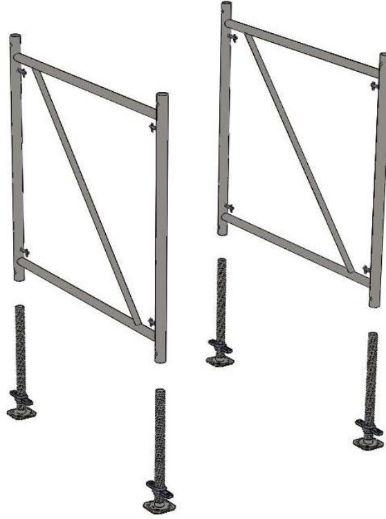
Şekil4.1. Alt ayar milleri üzerine çerçeve elemanlarının yerleştirilmesi
